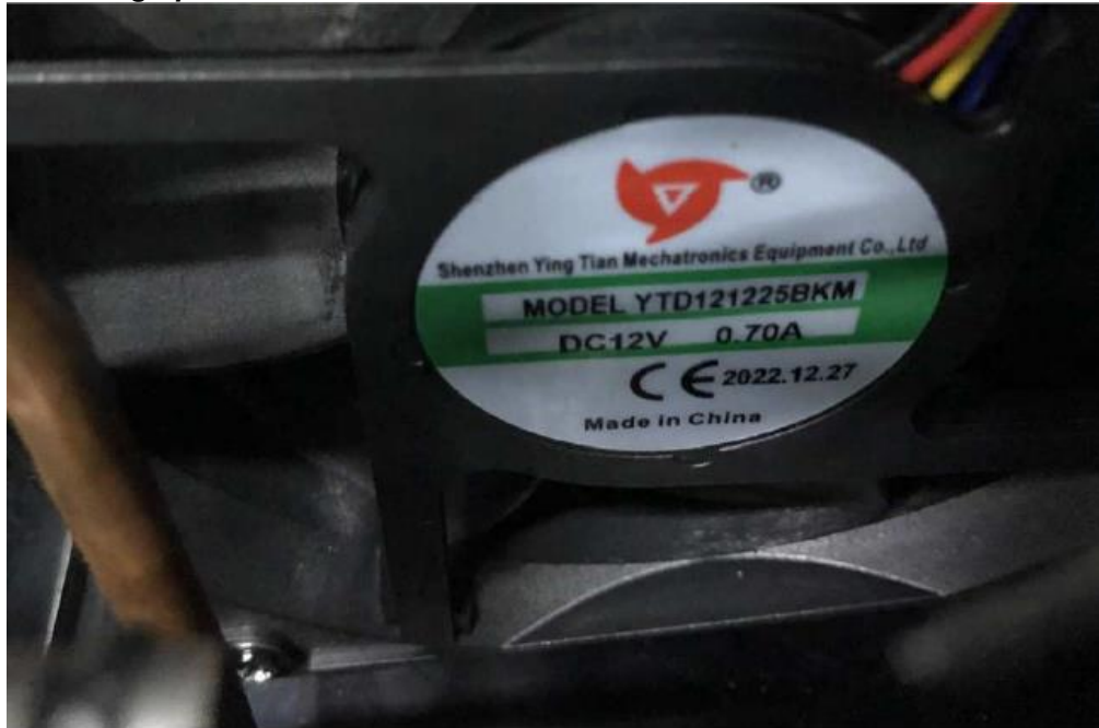
Fig.35- DC fan motor
